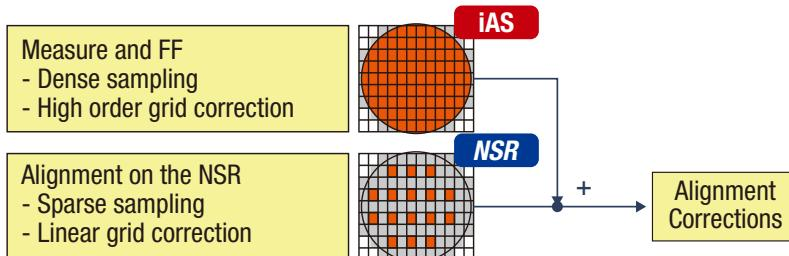
アライメントステーションとは、露光装置のスループットを落とすことなく高速・高精度でウェハを計測し、グリッドエラーの補正を可能にするシステムです。これをインラインで露光装置内に組み込んだものがiASになります。iASにより、スループットを低下させることなく、全ショットでの多点アライメントが可能になり、飛躍的な精度向上を実現しました。
