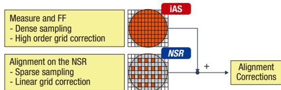
アライメントステーションとは、露光装置のスループットを落とすことなく高速・高精度にウェハを計測し、グリッドエラーの補正を可能にするシステムです。これをインラインで露光装置内に組み込んだものがiASになります。iASにより、スループットを低下させることなく、全ショットでの多点アライメントが可能になり、飛躍的な精度向上を実現しました。
